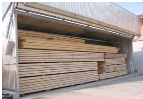
Technische Trocknung von MH ® -Massivholz durch vollautomatische und computergesteuerte Trockenkammern
